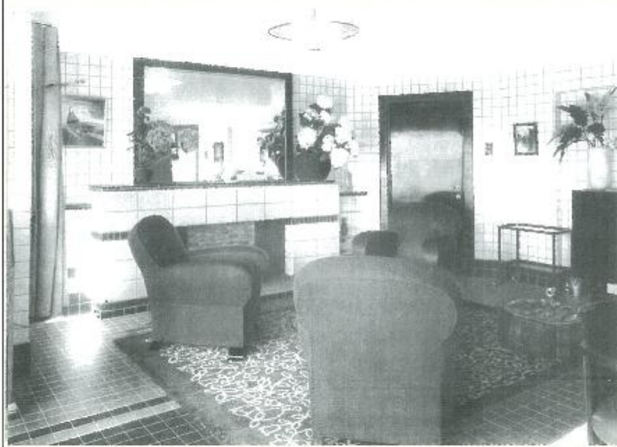
Le living-room de la villa « Yvette », l'arch. Vervaelcke, Le Zoute, pavée, lambrissée et décorée. Les revêtements muraux et la cheminée en grès émaillé, le pavement en grès Cérame « Cerabel » ont été posés par le maître carreleur, M. Rues Zinne, de Lothem Saint Martin.
